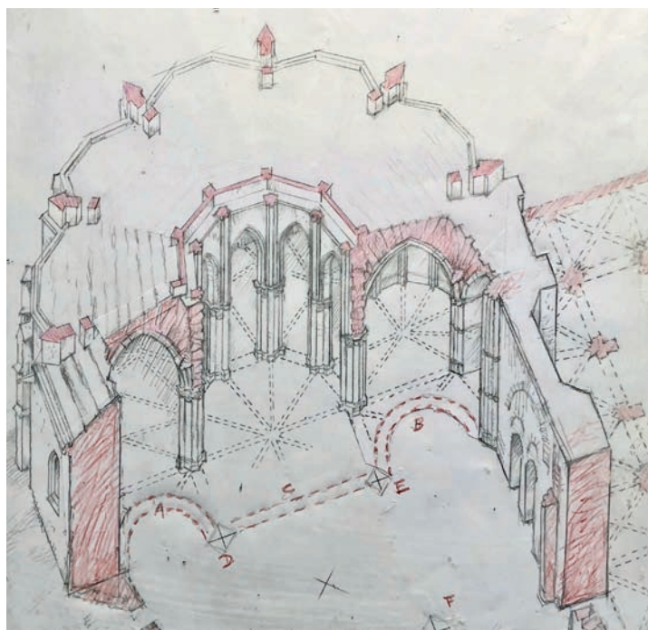
FIG. 1. ÉTAT DU CHANTIER AU TERME DE LA PREMIÈRE CAMPAGNE : rond-point, chevet, soubassement de la face méridionale du transept avec son double portail.
