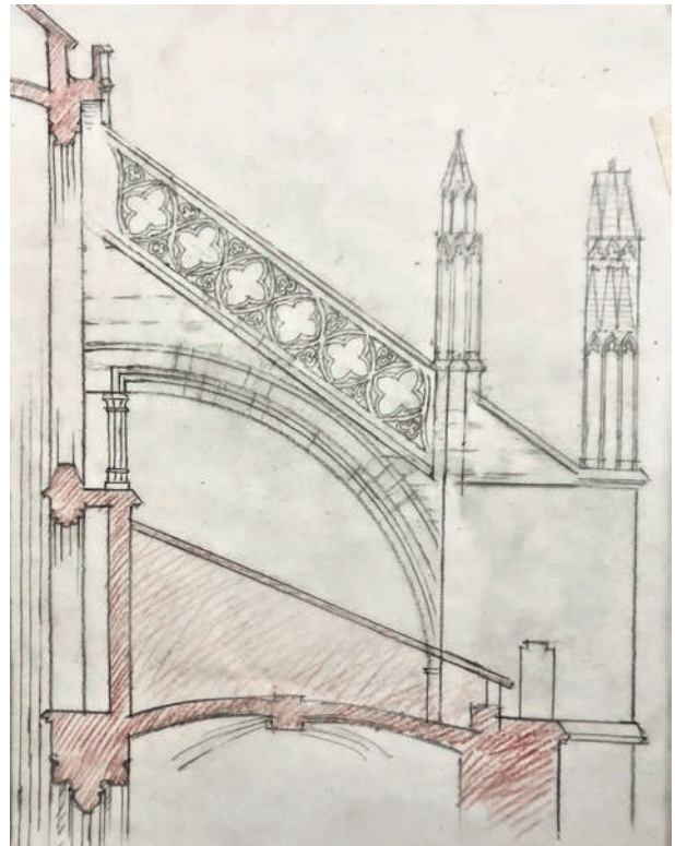
FIG. 22. ARC-BOUTANT DE LA TRAVÉE numéro 3. Relevé sommaire B. Sournia.
