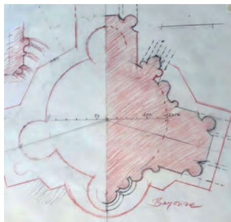
FIG. 20. BAYONNE, PILE CANTONNÉE DU ROND-POINT : coupe au niveau du tailloir, croquis de travail. Dessin B. Sournia.
