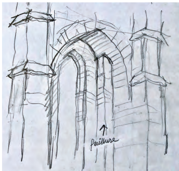
FIG. 12. HYPOTHÈSE ALTERNATIVE à celle représentée sur la figure 12 et finalement non retenue : l'arc enjambe la feuillure et s'appuie sur les deux contreforts. Croquis B. Sournia.
