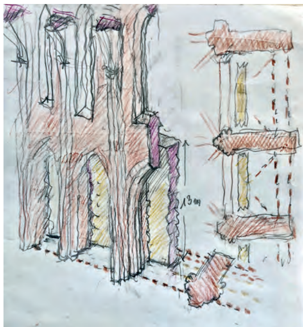
FIG. 2. SECTION DE LA NEF. Hypothèse de Maurice Prin des deux murs « emboîtés l'un dans l'autre ». Croquis B. Sournia.
